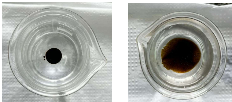
Figura 6 e 7. Comportamento das emulsões sintetizadas com solução salina de 30% e 40% no teste de gota.
